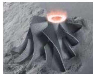
Bild 1: Additive Fertigung metallischer Bauteile mittels Laser Metal Fusion (LMF) (Quelle: TRUMPF Gruppe)
